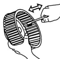
Figur 11. Fläkthjulets kåpa och fläktvingar rengöres med en borste.
