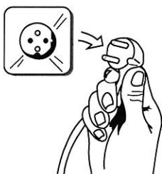
Figur 5. Före rengöring av värmeväxlare och fläktar etc skall aggregatet alltid göras spänningslöst.
