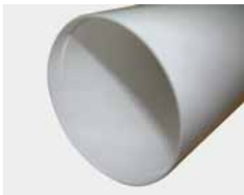
Rör MC37* med ljuddämpningsvärde 38 dB. Invändig diameter 100 mm, längd 500 mm.
